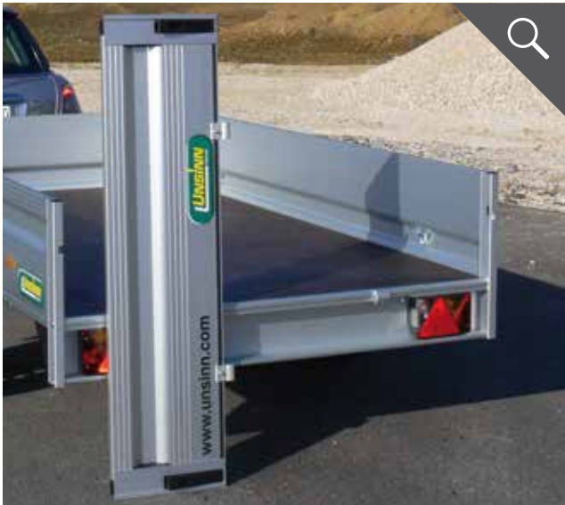
Heckbordwand komplett abnehmbar für langes Ladegut
