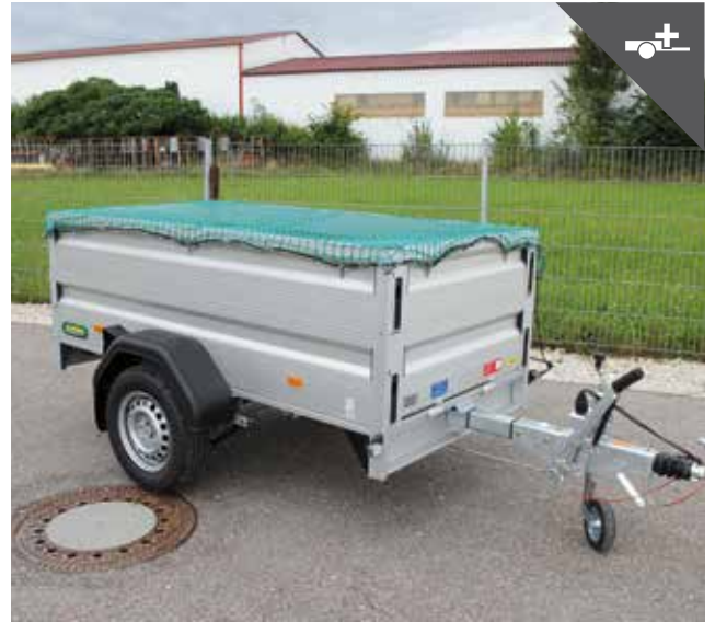
Bordwandaufsatz mit Ladungssicherungsnetz und Netzhaken
