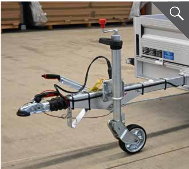
Deichsel mit Automatikstützrad und Rangiergriff für einfaches Handling
