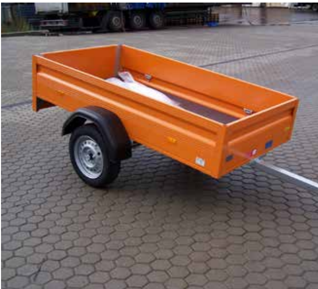
Pulverbeschichtete Bordwände (RAL-Farbe) für mehr Langlebigkeit
