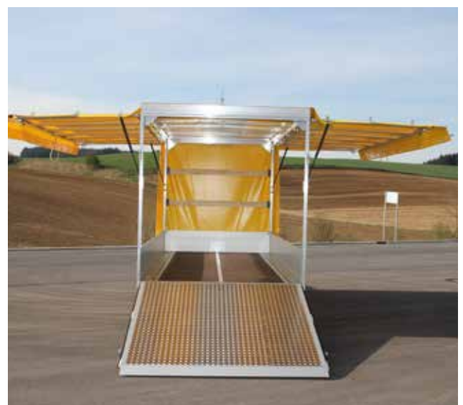
Sonderbau: Hochlader Typ GTP mit Planenaufbau und Auffahrklappe für den Transport von Fahrzeugen
