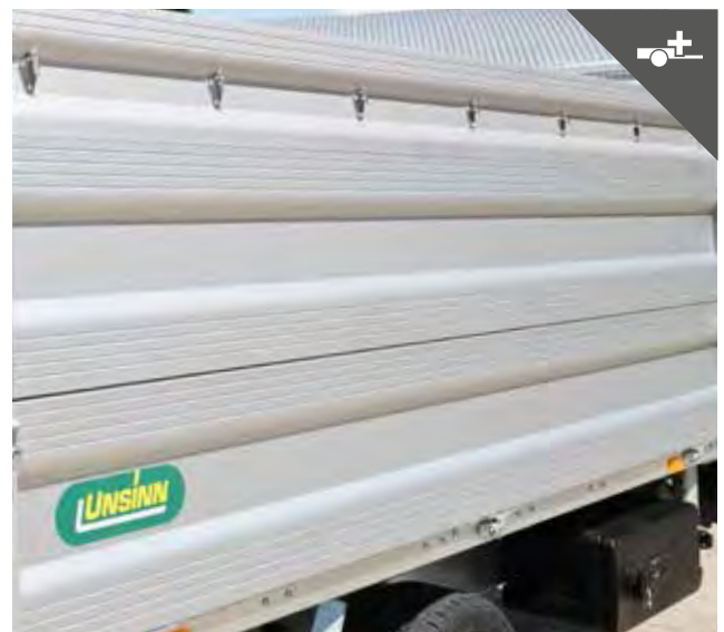
Bordwandaufsatz für mehr Ladevolumen
