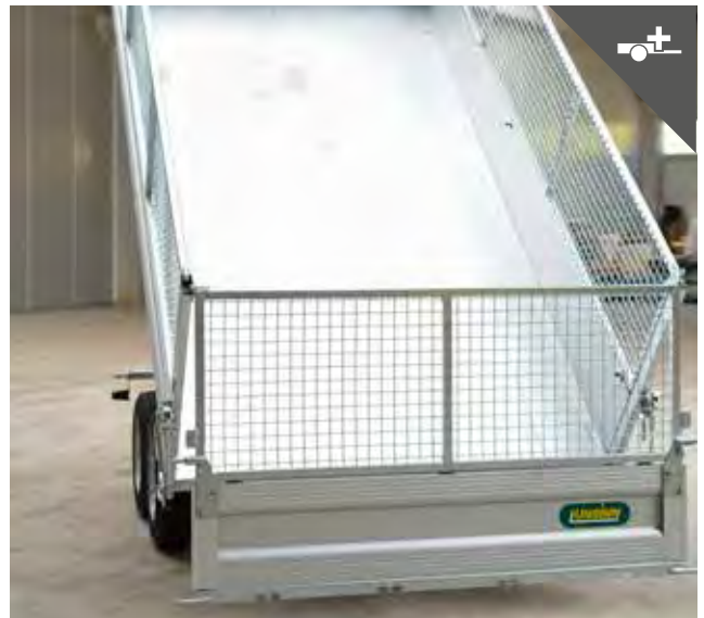
Welldrahtgitteraufsatz für mehr Ladevolumen
