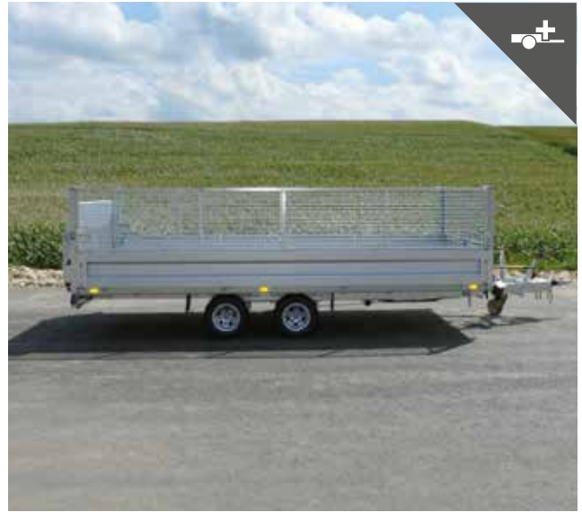
Welldrahtgitteraufsatz für mehr Ladevolumen
