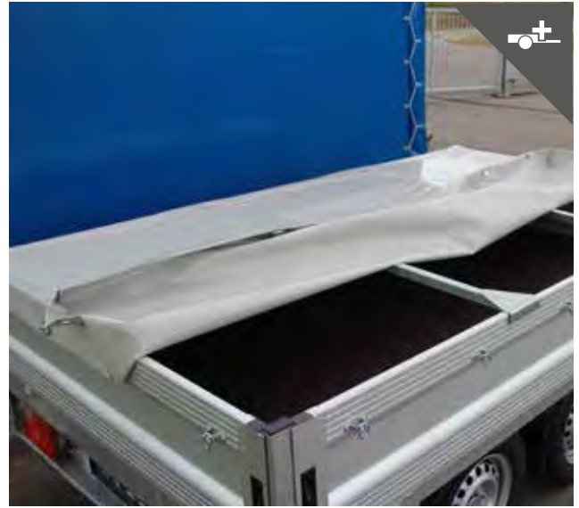
Flachplane mit Querstreben für den wetterfesten Transport
