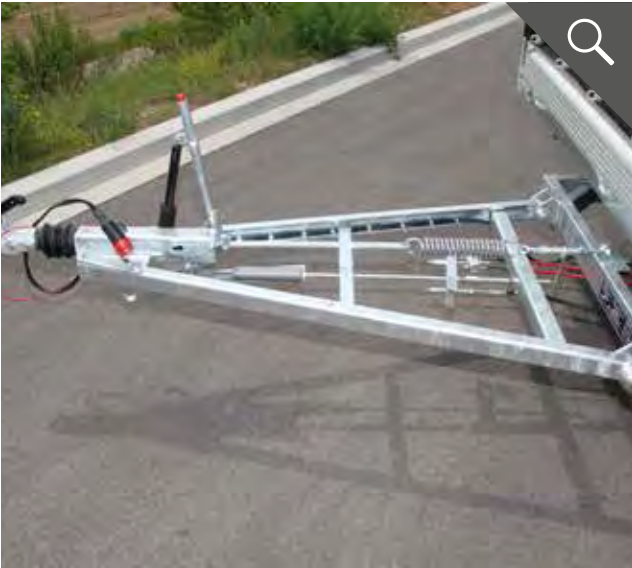
Zugdeichsel mit Drehkranz und Höhenverstellung
