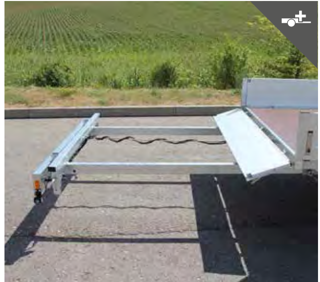
Heckleuchenträger bis 200 kg belastbar
