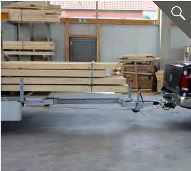
Maximale Zugdeichsellänge von 3.100 mm im Standard
