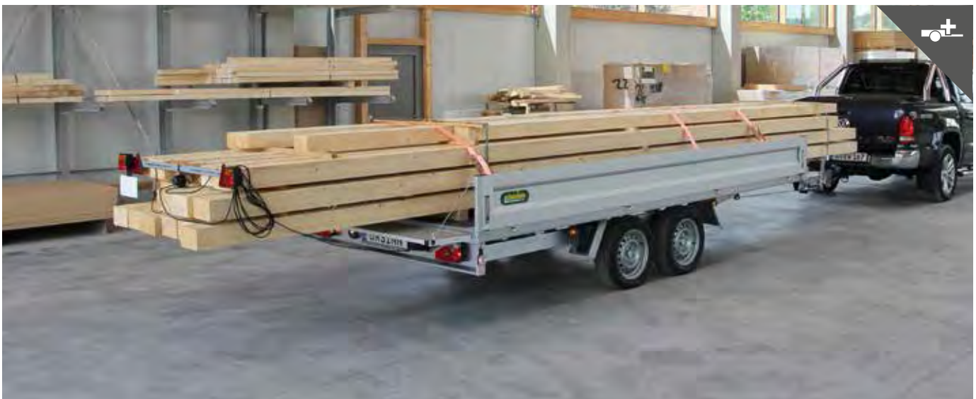
Zusätzlicher, mobiler Leuchenträger für mehr Sicherheit
