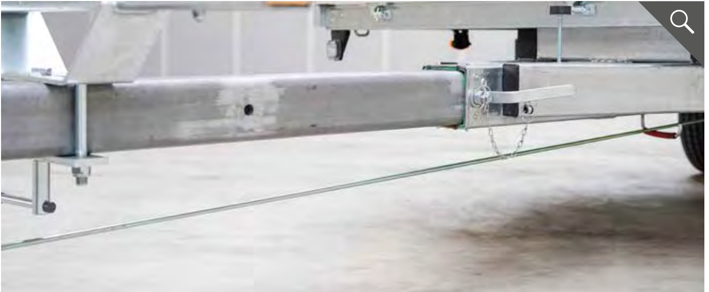
Zugdeichsel einfach ohne Werkzeug ausziehbar
