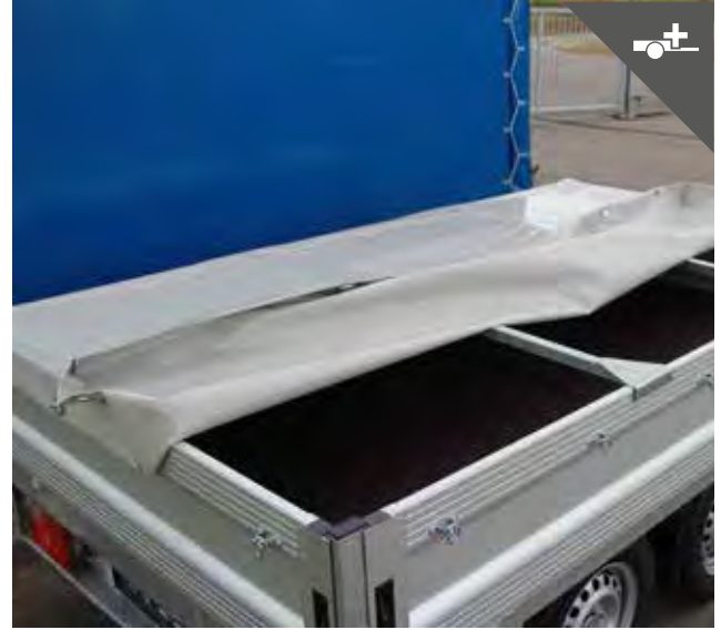
Flachplane mit Querstreben für den wetterfesten Transport
