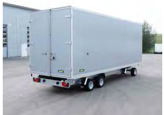
Sonderbau: Drehschemelanhänger Tridem mit Kofferaufbau für den witterungsgeschützten Transport
