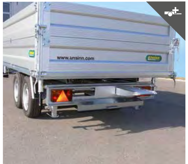
Alu-Auffahrschienen und Bordwandaufsatz für mehr Ladevolumen
