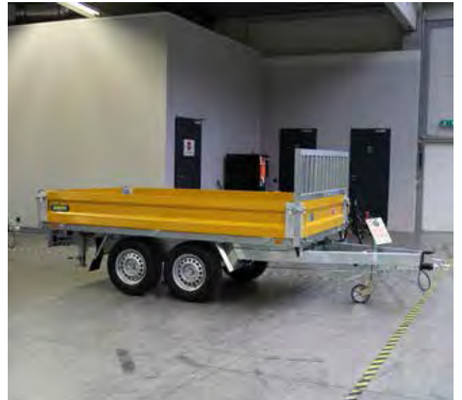
Pulverbeschichtete Bordwände Typ GTP
