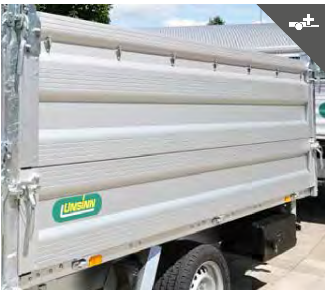
Bordwandaufsatz für mehr Ladevolumen
