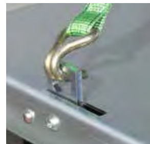
6 - 8 versenkte Zurringe mit je 600 kg Zugkraft
