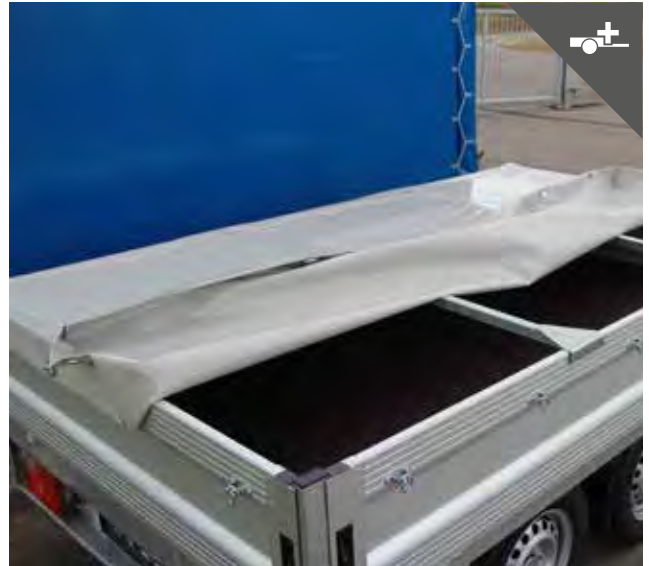
Flachplane mit Querstreben für den wetterfesten Transport
