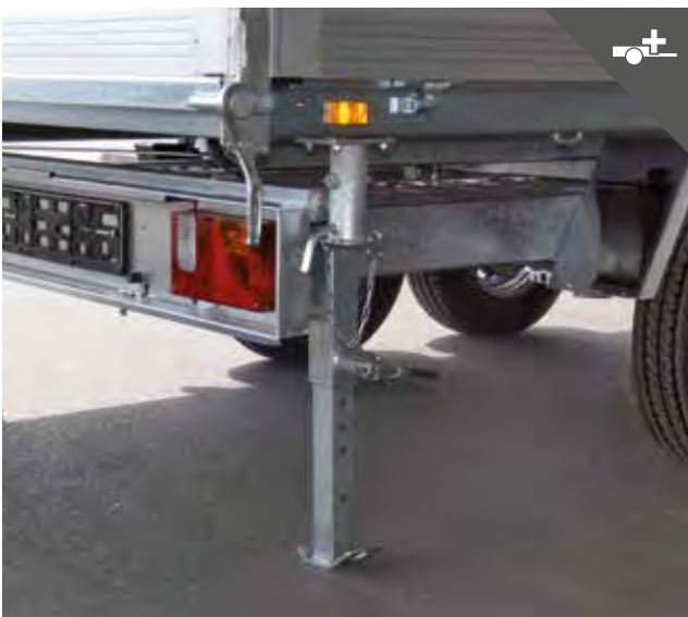
Stabile Abstützung für sicheres Be- und Entladen
