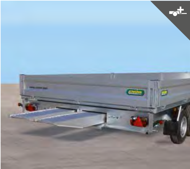
Halterung für Auffahrschienen unter der Ladefläche
