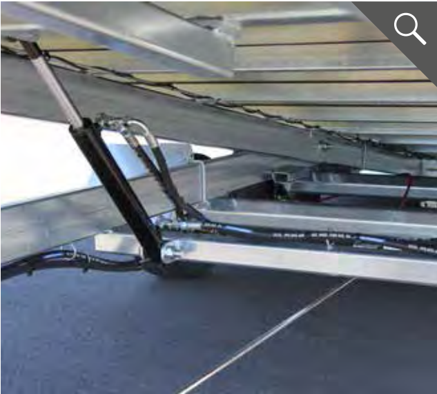
Doppeltwirkende Hydraulikzylinder für sicheres Beladen
