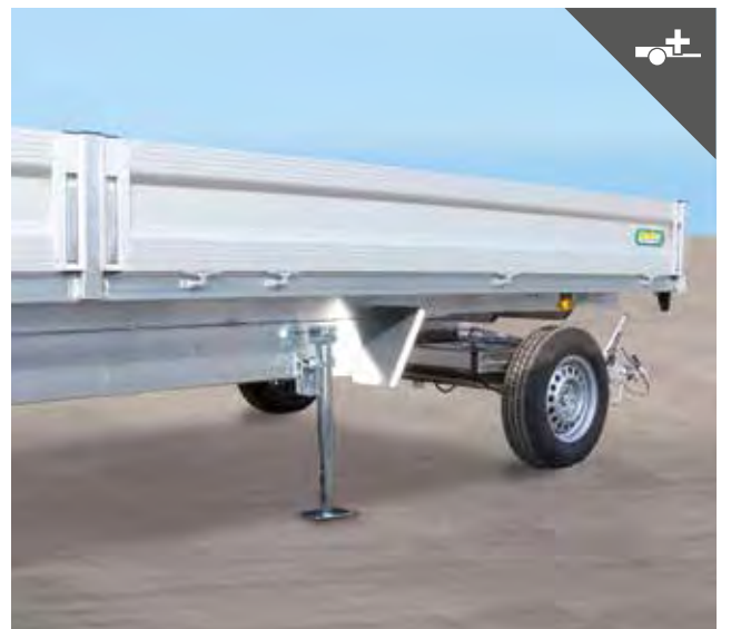
Kurbelstütze für einen sicheren Stand
