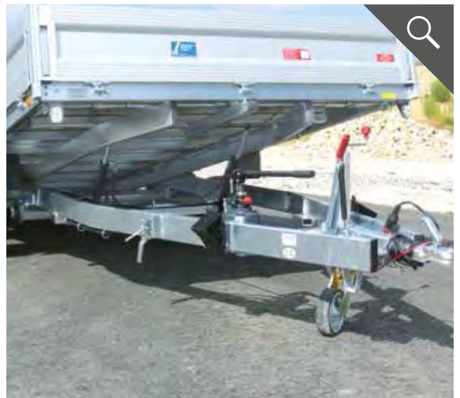
Verschweißter und feuerverzinkter Stahlrahmen
