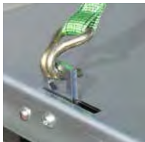
6 versenkte Zurringe mit je 600 kg Zugkraft
