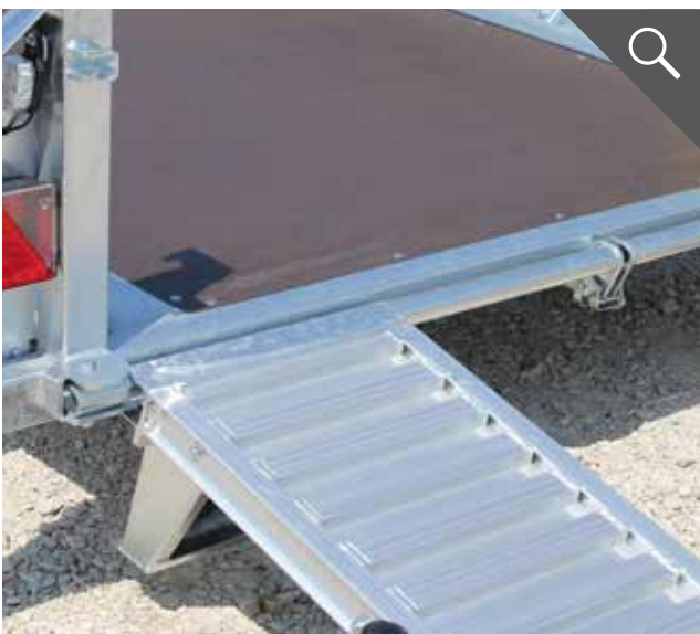
Auffahrrampen leicht zu verschieben für unterschiedliche Fahrzeugbreiten
