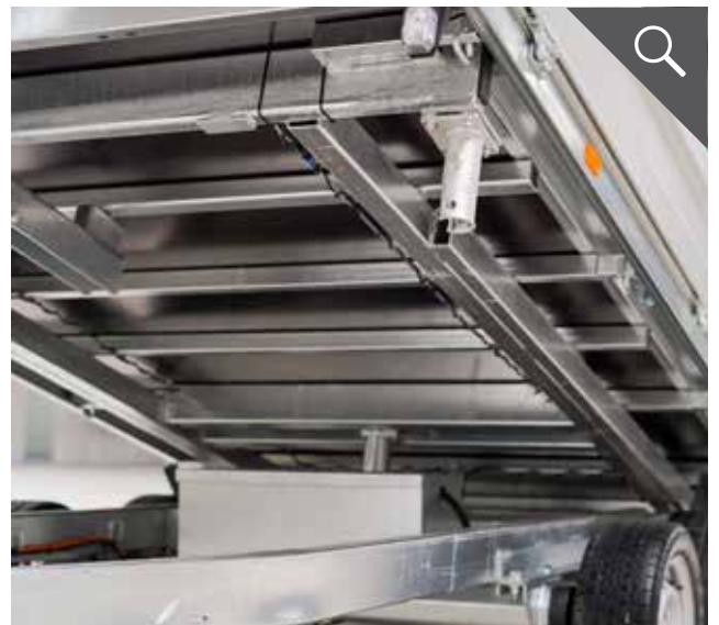
Verschweißter und feuerverzinkter Stahlrahmen
