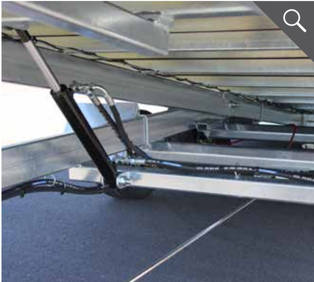
Doppeltwirkende Hydraulikzylinder für sicheres Beladen
