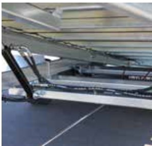
Ladefläche kippbar durch Schwerpunktverlagerung
