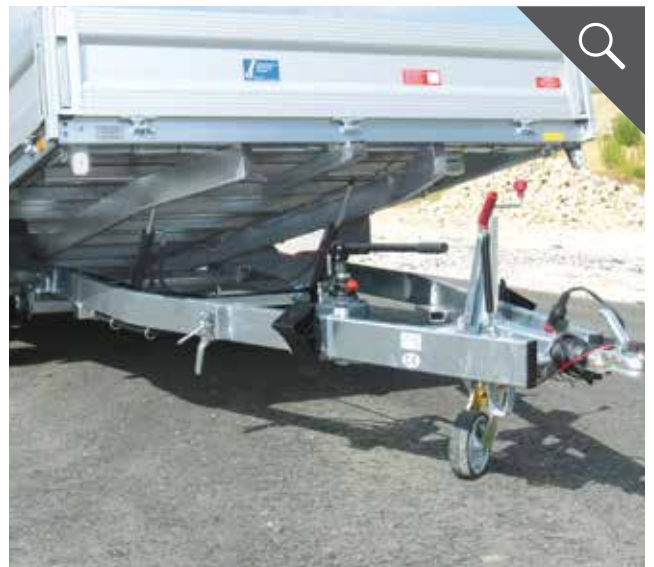
Verschweißter und feuerverzinkter Stahlrahmen
