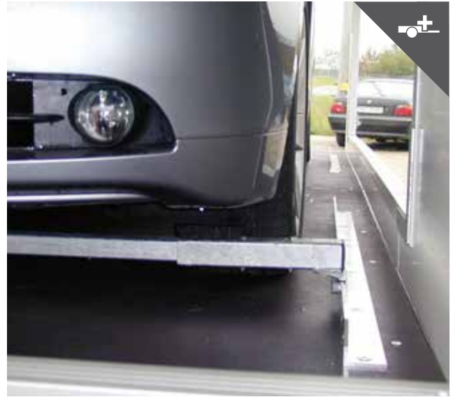
Radstopper für Fahrzeugbreite
