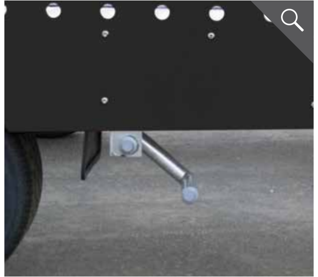
Quickstop-Fußbetätigung zum Entriegeln der Auffahrschienen
