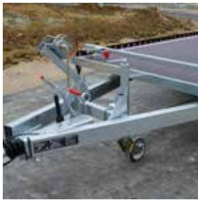
Rahmen aus geschweißtem Hohlrahmenprofil
