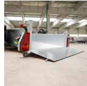
Flacher Auffahrwinkel mit 5°
