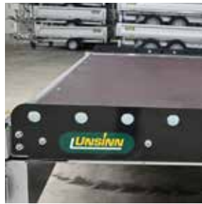
Seitenschürzen pulverbeschichtet in edel glänzendem Schwarzgrau RAL 7021
