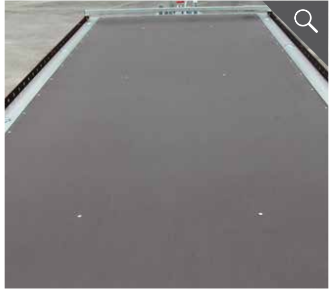
Durchgehende Bodenplatte ohne Stoß (18 mm)
