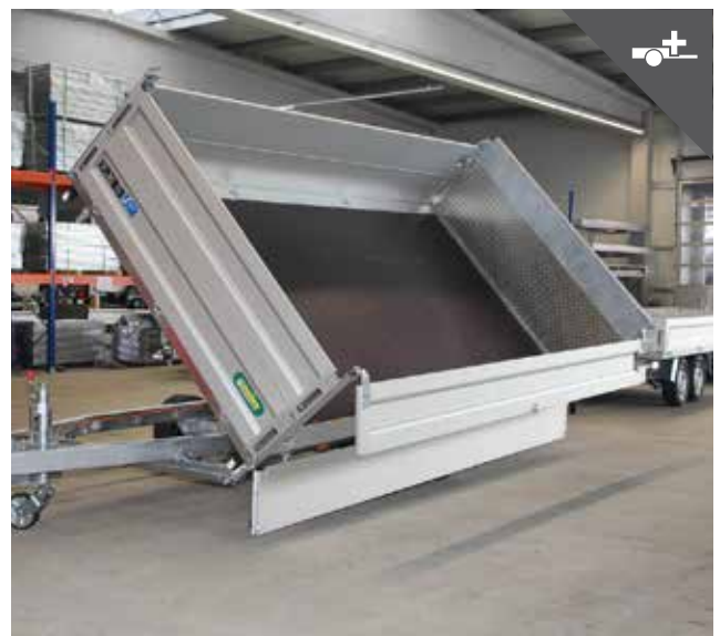
Bordwandaufsatz für mehr Ladevolumen
