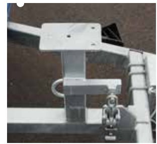
Windenbock für 900 kg Handseilwinde
