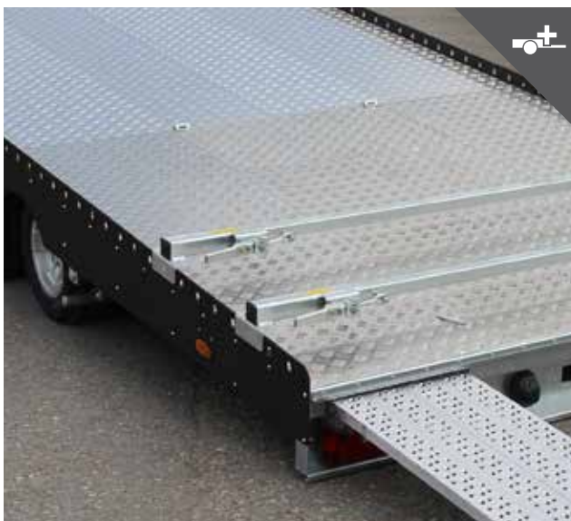
Radstopper für Fahrzeugbreite
