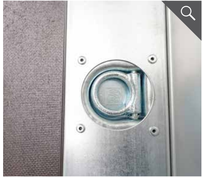
Zurrmulden versenkt im Bodenrahmenprofil, Dekra zertifiziert
