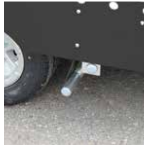
Einfache Entriegelung der Auffahrschienen durch Quickstop-Fußbetätigung
