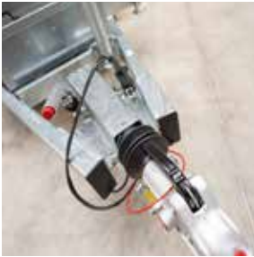
Rahmen aus geschweißtem Hohlprofil für Stabilität
