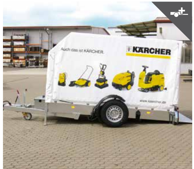
Typ GAS mit Planengestell und Hochplane vorne abge- schrägt um aerodynamische Vorteile zu nutzen
