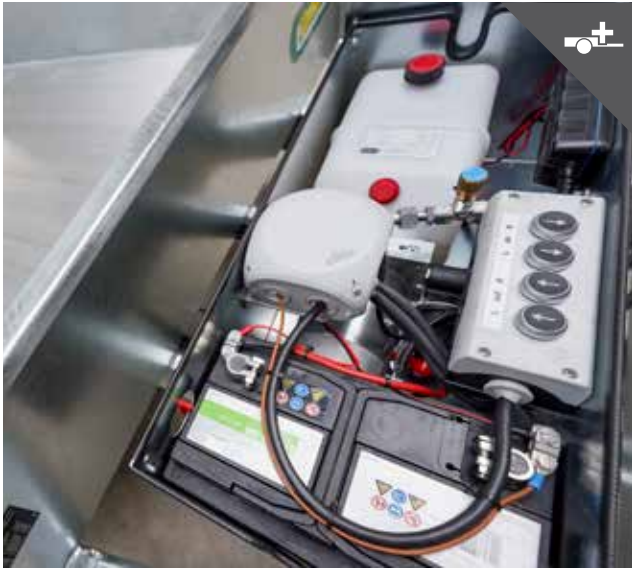
Leistungsstarke Elektrohydraulik wasser- und schmutzgeschützt
