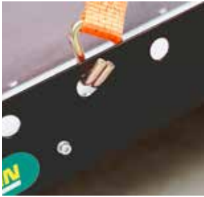
Seitenschürze in Schwarzgrau (RAL 7021) zur Ladungssicherung
