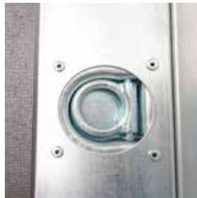
8 Zurmmulden versenkt im Bodenrahmenprofil Dekra zertifiziert
