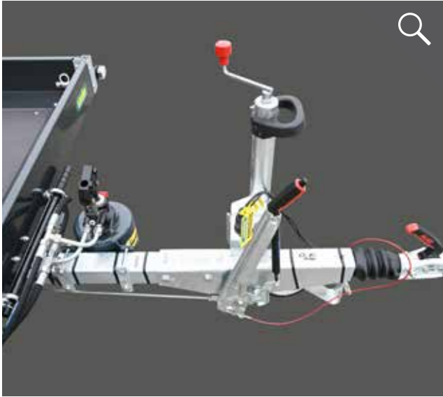
Verstärktes und automatisches Stützrad mit Rangiergriff
