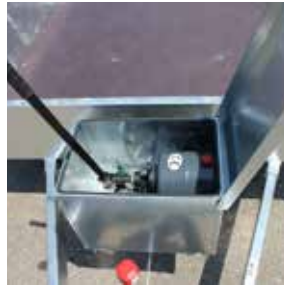
Hydraulikanlage mit Senkventil und Handpumpe (absenkbar in an- und abgehängtem Zustand)
