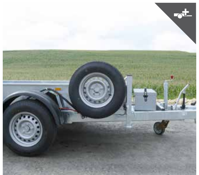
Ersatzradhalter für Bordwandmontage
