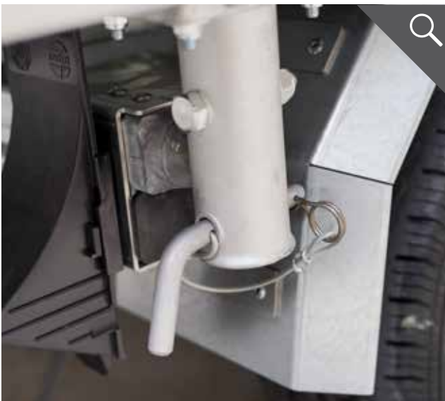
Umsteckbolzen für die Kippfunktion
