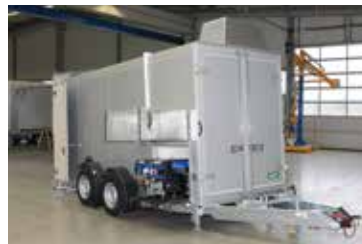
Robuster Kofferaufbau aus Sandwich-Paneelen
