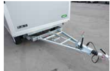
Stützlastunabhängig durch freitragende V-Deichsel
