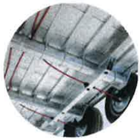
Extrem starke Bodenunterstützung durch viele Rohrprofile
