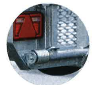
Heckklappe mit Torsionsfedern
