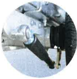
Zubehör: Achsstoßdämpfer für zusätzlichen Fahrkomfort
