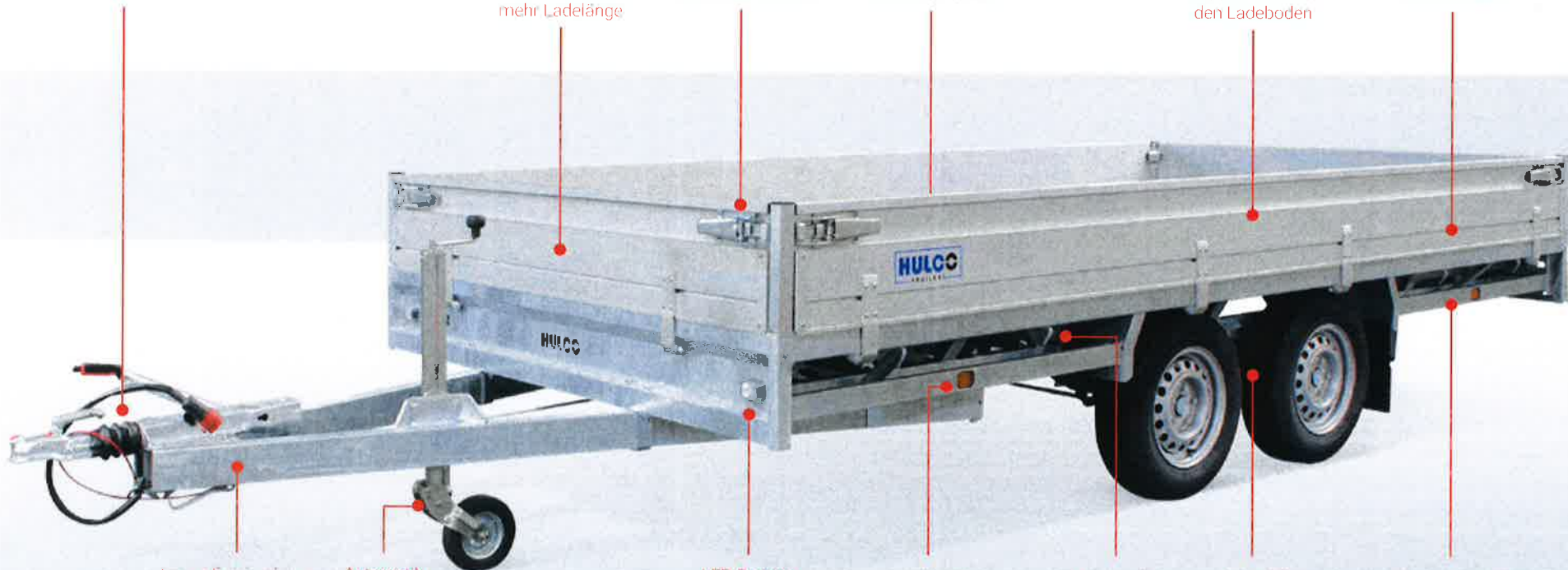
Lange Deichsel aus Rechteckrohrprofil
